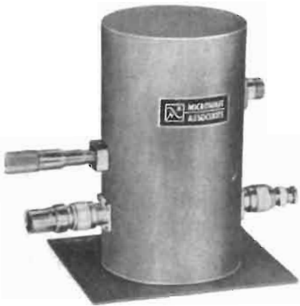
Fig. 2 - Amplificatore parametrico, studiato da F. S. Harris, con un fattore di rumore di circa 1 dB.
