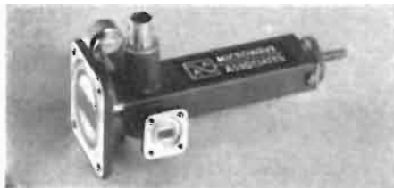
Fig. 3 - Moltiplicatore di frequenza (generazione di armoniche) a diodo varactor.
