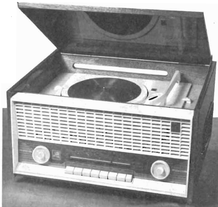
Fig. 1 - Aspetto della soluzione Midget del ricevitore AM-FM, mod. ES-61.
