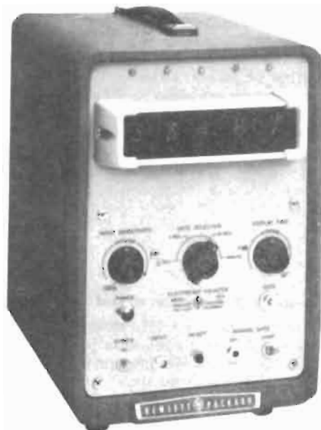
La HEWLETT PACKARD ha presentato recentemente due nuovi contatori elettronici, mod. 5211 e 521E. Quest'ultimo modello consente la lettura di cinque cifre significative, mentre il mod. 1) consente la lettura di quattro cifre significative. Entrambi hanno possibilità di funzionare tra 1 Hz e 120 kHz con una precisione rispettivamente dello 0,1% e dello 0,01%. Ulteriori notizie possono essere ottenute dall'Agente generale per l'Italia, Ditta dr. ing. Mario Vianello, di Milano.
