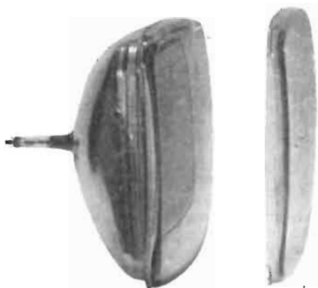
Fig. 1 - Il nuovo tubo con schermo di sicurezza direttamente saldato. (A destra). Lo schermo di sicurezza separato.
